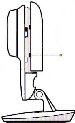
Чтобы снять заднюю крышку сожмите правый и левый нижние пазы и сдвиньте крышку вверх.
